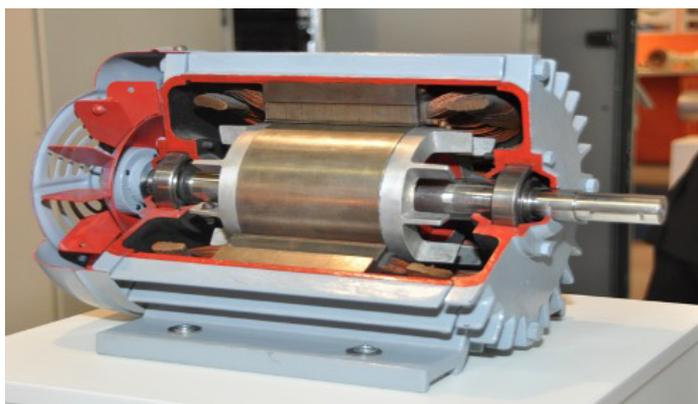
*Sezione di motore elettrico*
